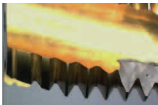
切屑控制有问题时的崩刃示例
