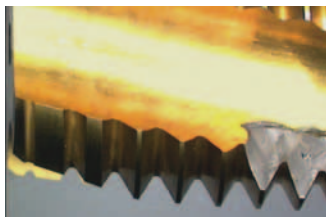
Exemple d'écaillages dus à des problèmes de maîtrise des copeaux
