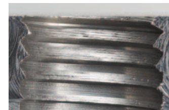
Rosca de agujero pasante con error de corte axial
