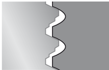
Rosca con error de corte axial con herramientas con hélice a derechas: error de corte en parte inferior de flancos
