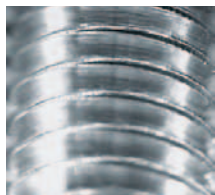
Superficie con lubricación excelente
