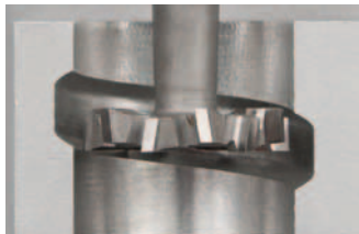
Paso P = 12, distorsión de perfil existente
