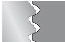
Rosca con error de corte axial con machos de roscar con hélice a izquierdas o con machos de roscar con corte inicial de roscado: error de corte en parte superior de flancos
