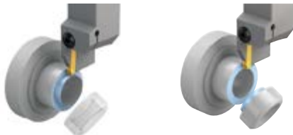
Linker Schneideinsatz: Grat links am Rohr
