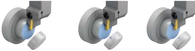
Linker Schneideinsatz: Butzen an der Stange
