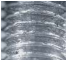
Schuppige Oberfläche bei unzureichender Schmierung; Abhilfe: Schmiernuten
