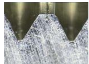
Gewindeprofil mit Sonderformer
