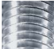
Glatte Oberfläche bei hervorragender Schmierung
