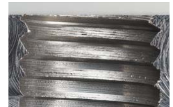
Axial verschnittenes Durchgangsgewinde
