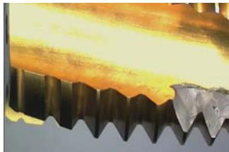
Beispiel für Ausbrüche bei Problemen mit der Spanbeherrschung
