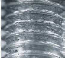
schuppige Oberfläche bei unzureichender Schmierung; Abhilfe: Schmiernuten
